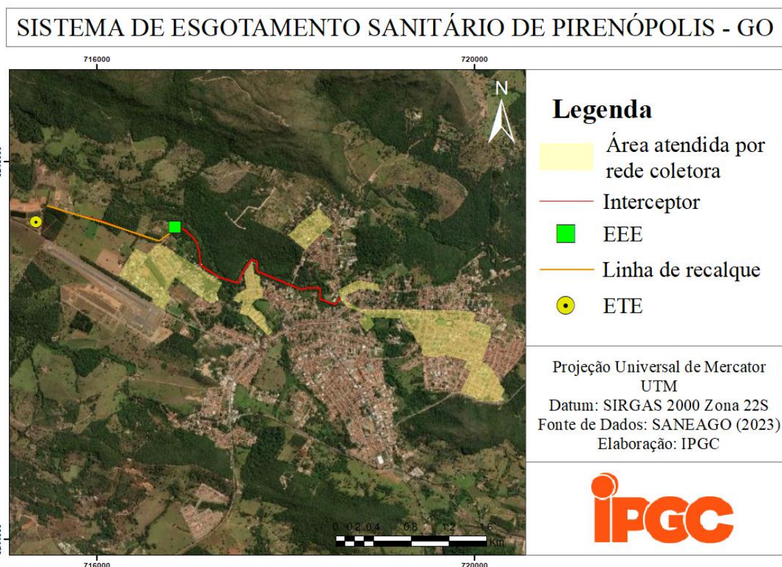
Figura 55 – Sistema de Esgotamento Sanitário (Sede)
