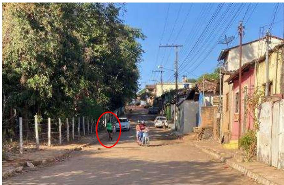
**Figura 7.85:** Devido às más condições de acessibilidade (subdimensionamento, obstáculos, pavimentação inadequada, avanço da ocupação privada), as pessoas caminham na faixa de rolamento dos veículos.
