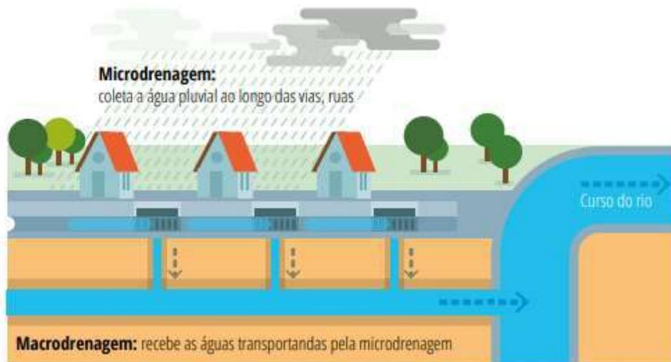
**Figura 6.81:** Sistema de Drenagem tradicional.
