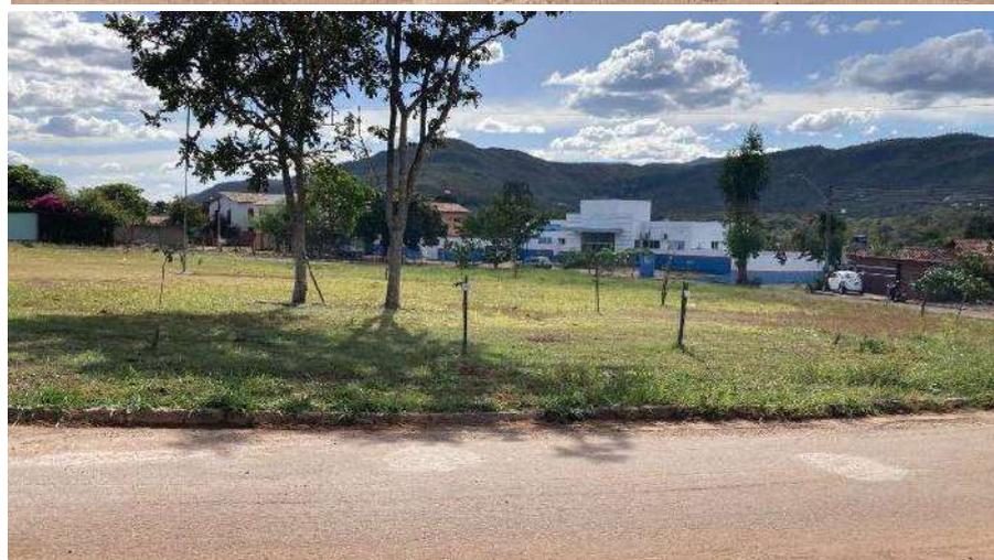
**Figura 7.82:** Grande rotatória no Jardim dos Pirineus. Área de alagamento. Necessita a implantação de infraestrutura de drenagem.
