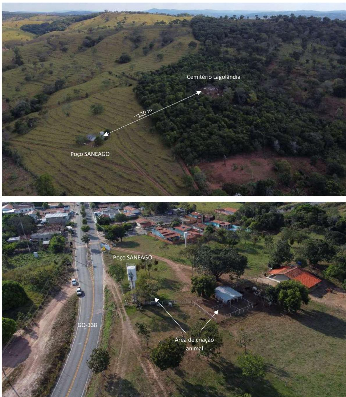
**Figura 6.35:** Captação da SANEAGO por poços na zona rural. A) Poço em Lagolândia situado topograficamente abaixo do cemitério local. B) Poço em Placas próximo a áreas de criação de animais.
